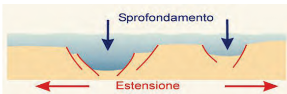
fig. 4 - La crosta continentale reagisce alle tensioni tettoniche scomponendosi lungo faglie inclinate, che separano blocchi che sprofondano e blocchi che restano alti
