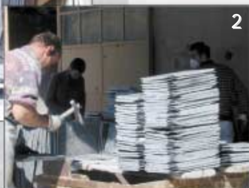
Foto 1: fenditura del blocco Foto 2: rifinitura delle lastre per copertura tipo montagna Foto 3: rifinitura delle lastre a coda di rondine per copertura alla svizzera Foto 4: foratura delle lastre Foto 5: stoccaggio delle lastre
