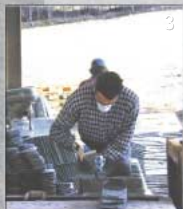
Foto 1: fenditura del blocco Foto 2: rifinitura delle lastre per copertura tipo montagna Foto 3: rifinitura delle lastre a coda di rondine per copertura alla svizzera Foto 4: foratura delle lastre Foto 5: stoccaggio delle lastre
